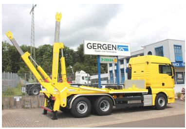
Links: Teleskoparme und Kippfunktion einzeln steuerbar zum optimalen Erreichen und zum sicheren Aufstellen von Wechselsilos
