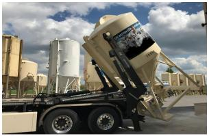
Oben: TAK Z4 — mit WS 12,5 - optionale Zusatzausrüstung für PFT-Silo erhältlich
