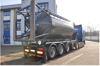
Silosattelauflieger: Filter mit Seitenaufnahme - geeignet für Rundsilos bis 22,5 m³ und DIN-Behälter von 4.000 - 7.000 mm im Lichten
