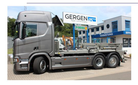
TAK 25 Z4 — einsetzbar für Wechselsilos nach DIN 30734 12,5 bis 22,5  $m^3$
